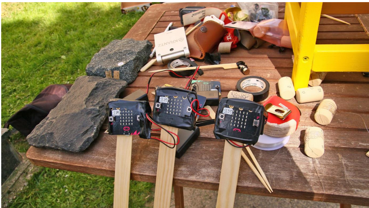
Slika 21. Micro:bit računala priređena za mjerenje gravitacijskog polja Zemlje.
