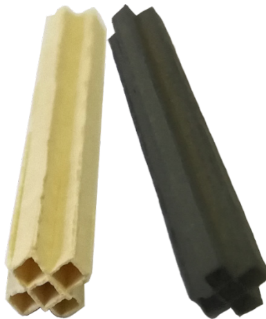
Slika 17. Monolitni kordijeritni katalizator prije (lijevo) i nakon (desno) nanošenja katalitički aktivne komponente (Mn-CuO x )
