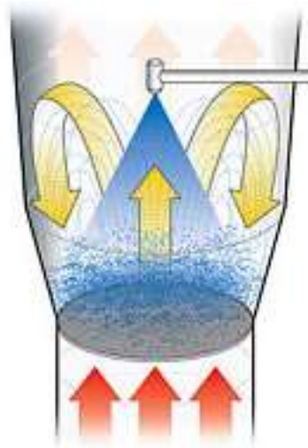
Slika 10. Prikaz granuliranja u fluidiziranom sloju gornjim raspršivanjem (Anonymous 3, 2016)
