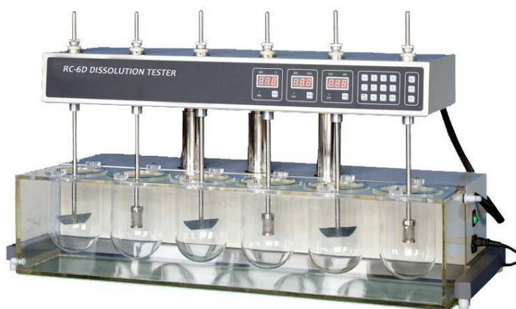
Slika 21. Uređaj za ispitivanje oslobađanja djelatnih tvari ( RC-6D, Zhengzhou Nanbei Instrument )
