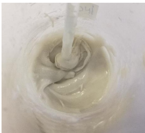
Slika 15. Mješavina rastaljenog PEG-a i DNR-a
