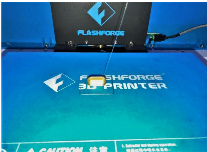
Slika 37. Postupak 3D-tiskanja tablete
