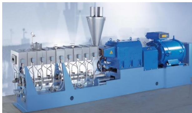
Slika 8. Prikaz pužnog (vijčanog) ekstrudera
