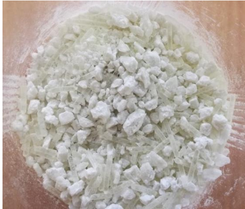
Slika 16. Čvrsta disperzija pomiješana s PVA-filamentom
