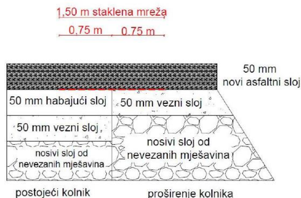
Slika 20. Uvjeti primjene staklene mreže na pukotinama nastalim na proširenjima kolnika [20]
