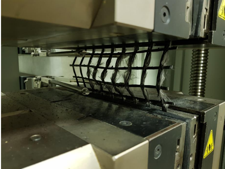
Slika 29. Deformacija gume 70 shorea prilikom ispitivanja uzorka staklene mreže
