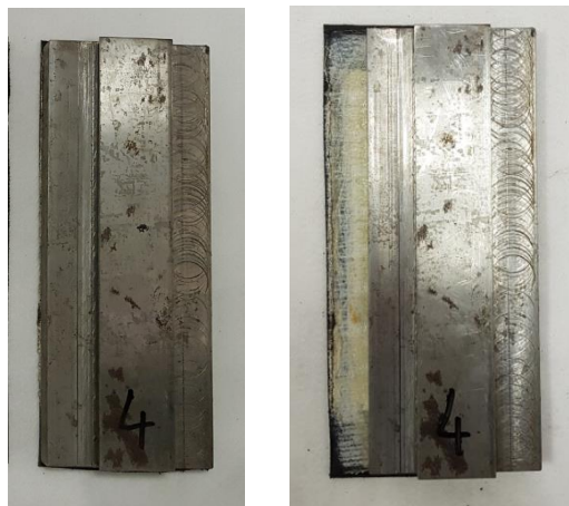
Slika 26. Prikaz klješta prije početka ispitivanja (lijevo) i nakon završenog ispitivanja (desno)
