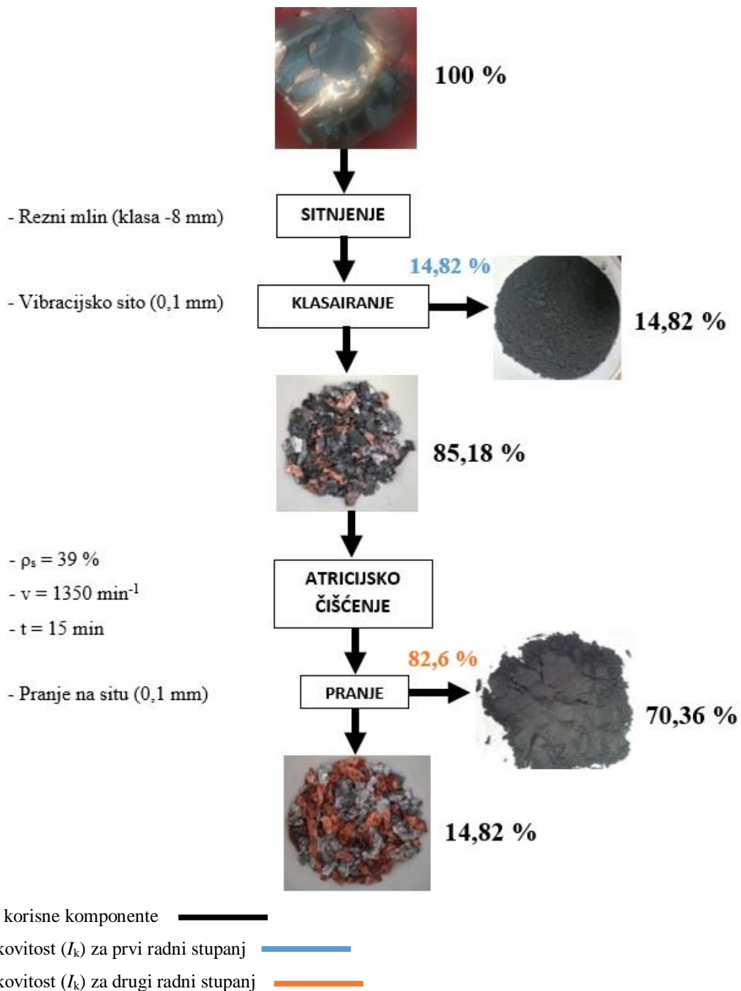
Slika 7-4 Proces direktnog fizičkog recikliranja
