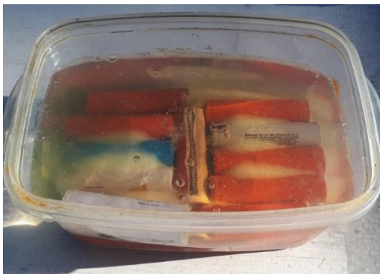
Slika 6–11 Pražnjenje Li-ion baterija u vodenoj otopini NaCl-a (na početku)
