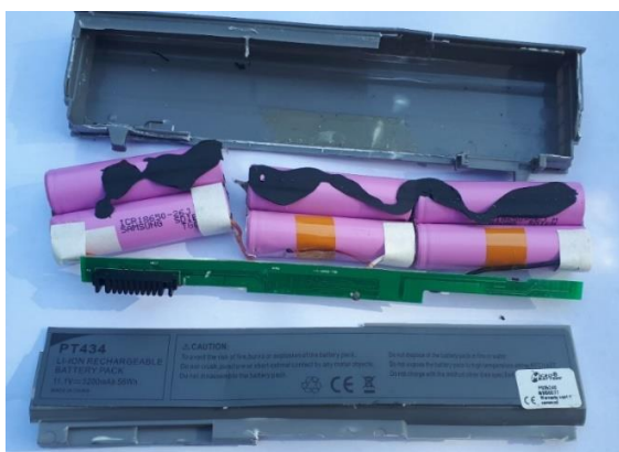
Slika 6-10 Dijelovi baterije prijenosnog računala
