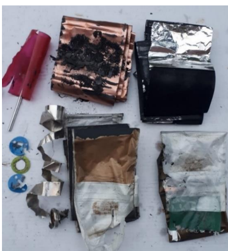
Slika 6-14 Dijelovi Li-ion baterije (razmotani svitak)
