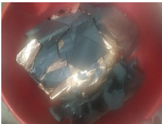
Slika 6–15 Izdvojene aluminijske folije s \text{LiCoO}_2 i bakrene folije s grafitom klase +8 mm
