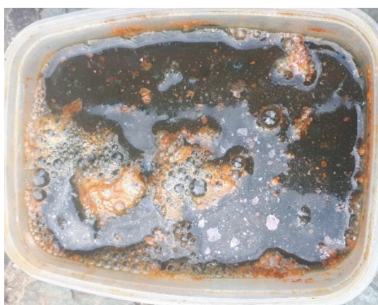
Slika 6–12 Pražnjenje Li-ion baterija u vodenoj otopini NaCl-a (nakon 24 sata)
