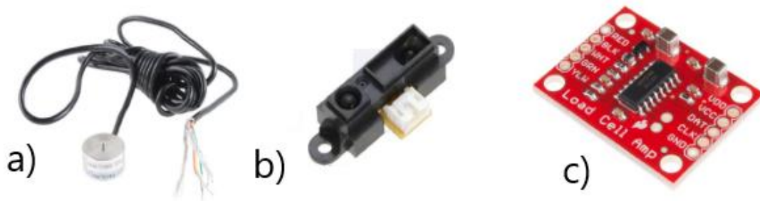
Slika 2 a) Senzor sile, b) Senzor pomaka Sharp, c) Pojačalo
