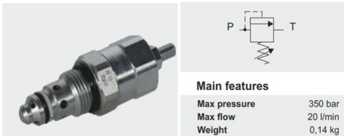
Slika 56 Ventil za ograničenje tlaka VMDC20A
