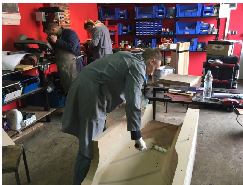
Slika 23. Premazivanje kalupa smolom.
