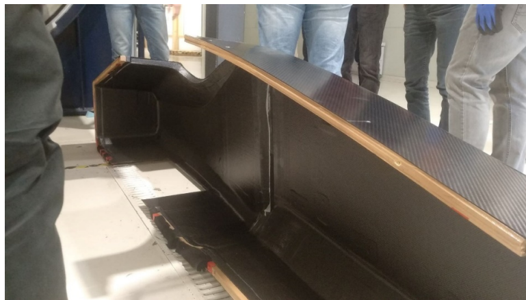
Slika 32. Unutrašnjost lijeve polovice monocoque šasije.
