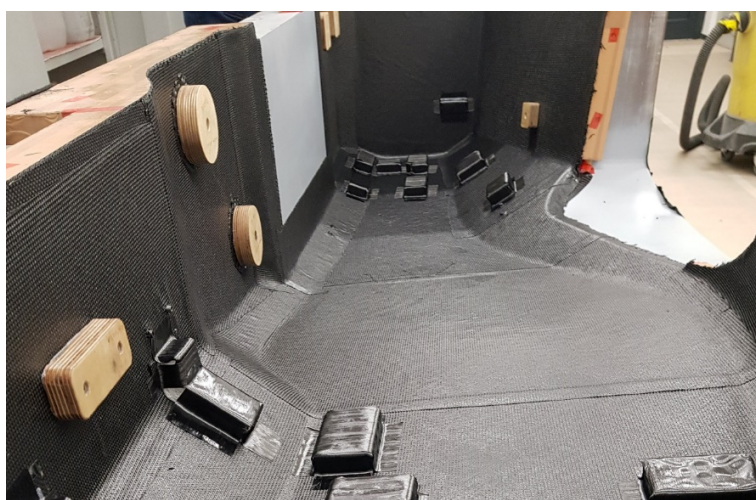
Slika 28. Umetci postavljeni na vanjsku koru sendvič paketa.
