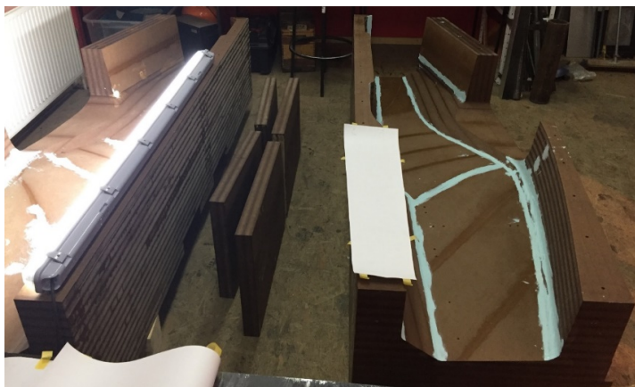
Slika 24. Popravljanje većih površinskih grešaka "auto kitom".
