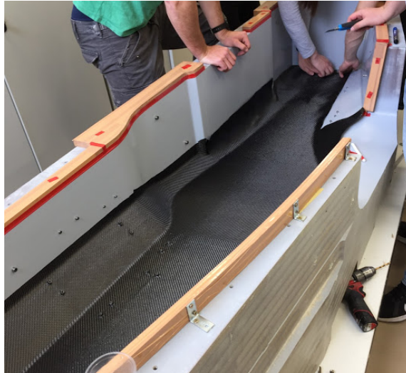
Slika 27. Postavljanje preprega u kalup.
