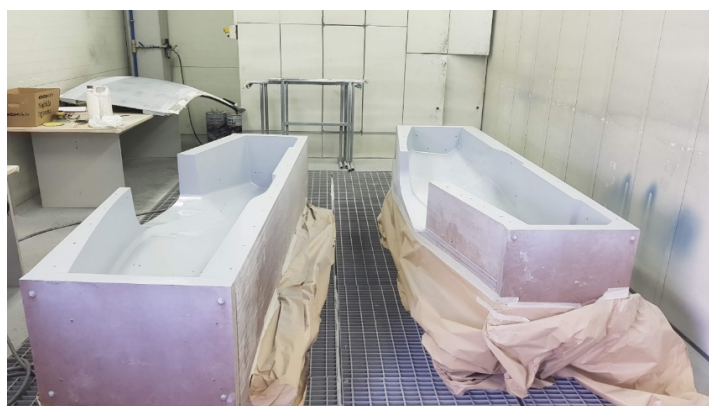
Slika 25. Nanošenje kita u obliku laka na površinu kalupa.
