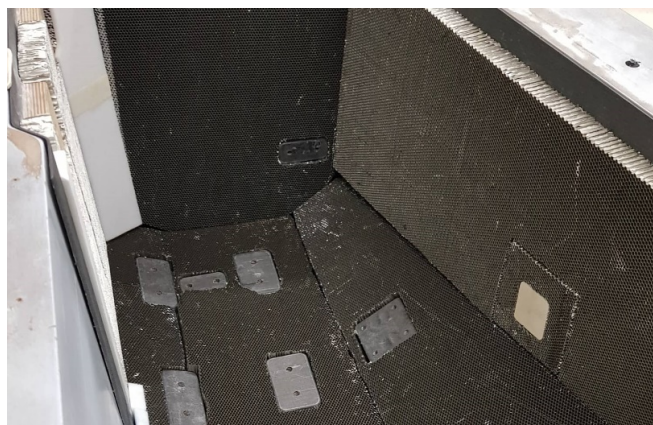
Slika 30. Postavljanje jezgri na vanjsku koru sendvič paketa.
