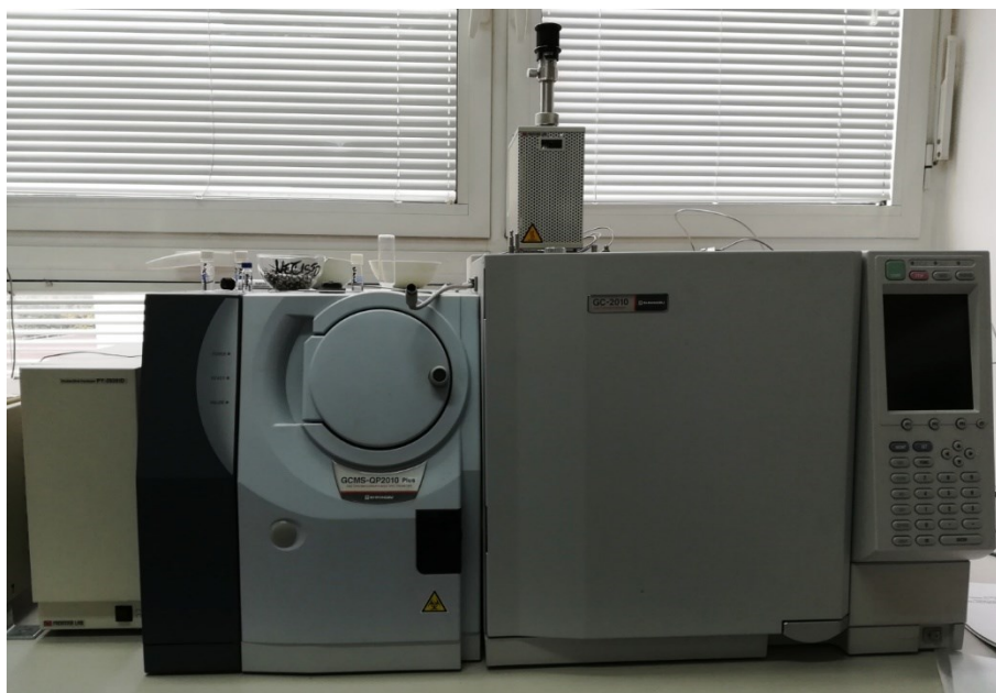
Slika 21. Plinski kromatograf s masenim spektrometrom Shimadzu GCMS-QP2010 Plus u vezanom sustavu s pirolitičkom jedinicom Frontier Lab PY-2020iD.
