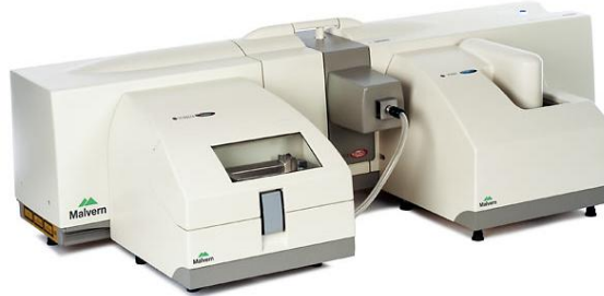
Slika 13. Uređaj za određivanje veličine čestica (Malvern, Mastersizer 2000)
