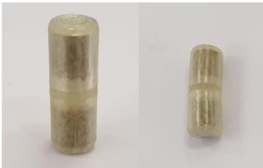
Slika 31. 3D printane PVA kapsule punjene liofiliziranim biljkama
