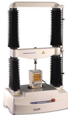
Slika 20. TA.HDPlus analizator teksture (Stable Micro Systems)
