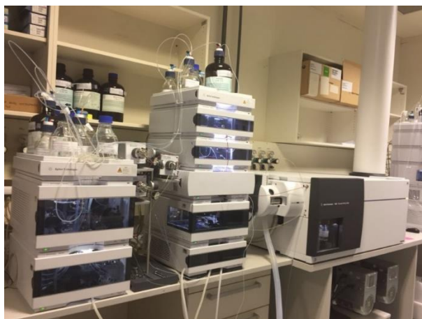
Slika 3.4. Tekućinski kromatograf ultra visoke djelotvornosti povezan sa spektrometrom masa visoke razlučivosti (2D-UHPLC-QTOF)
